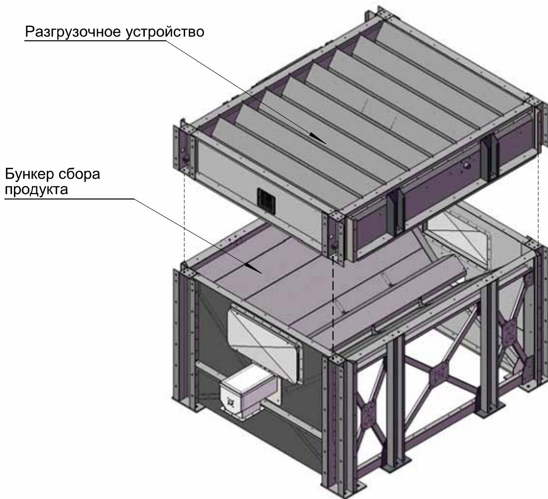
Одноблочная фундаментная рама содержит разгрузочное устройство и бункер сбора высушенного продукта. Между бункером и полом имеется зазор, чтобы в него проходил рециркулируемый воздух и чтобы было возможно осуществить общую чистку дна.
