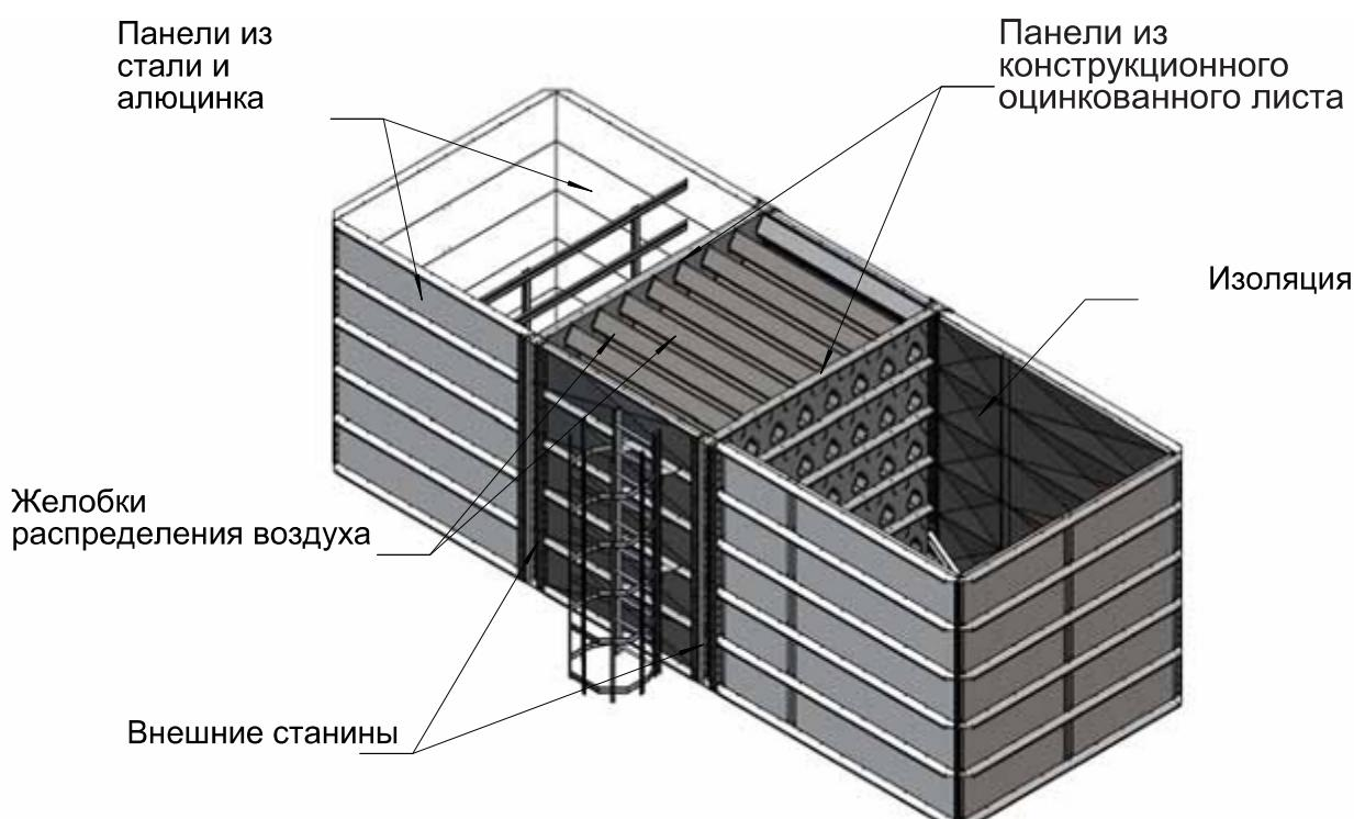
Отсеки распределения воздуха выполнены из панелей из алюцинка, материала, обладающего повышенным сопротивлением к атмосферным агентам. Панели распределения горячего воздуха изолированы с помощью слоя в 50 мм минеральной ваты и прижимной панели из оцинкованного листового железа.
