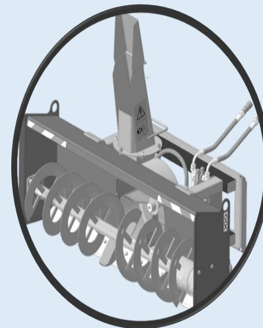
За счет отвалообразной формы стенки снег сразу затягивается к ротору.
