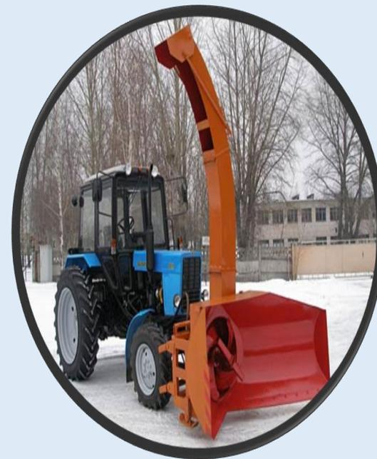
При одноступенчатой конструкции снегоотбрасыватель работает больше как отвал.
