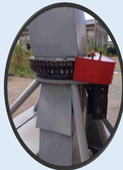
При работе всегда много снега, часто с песком, попадают на оборудование. Без защиты абразивное действие песка и грязи сломают оборудование в считанные дни.
