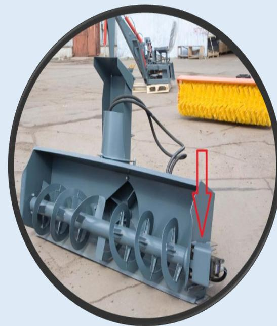
За счет такой конструкции, за габариты оборудования не выступают гидромоторы или
