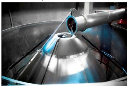
Центральный шнек из стали Hardox
