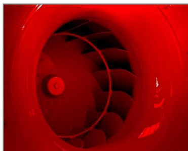
Бесшумный центробежный вентилятор
