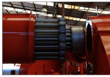
Топочный блок из трех видов легированной стали
